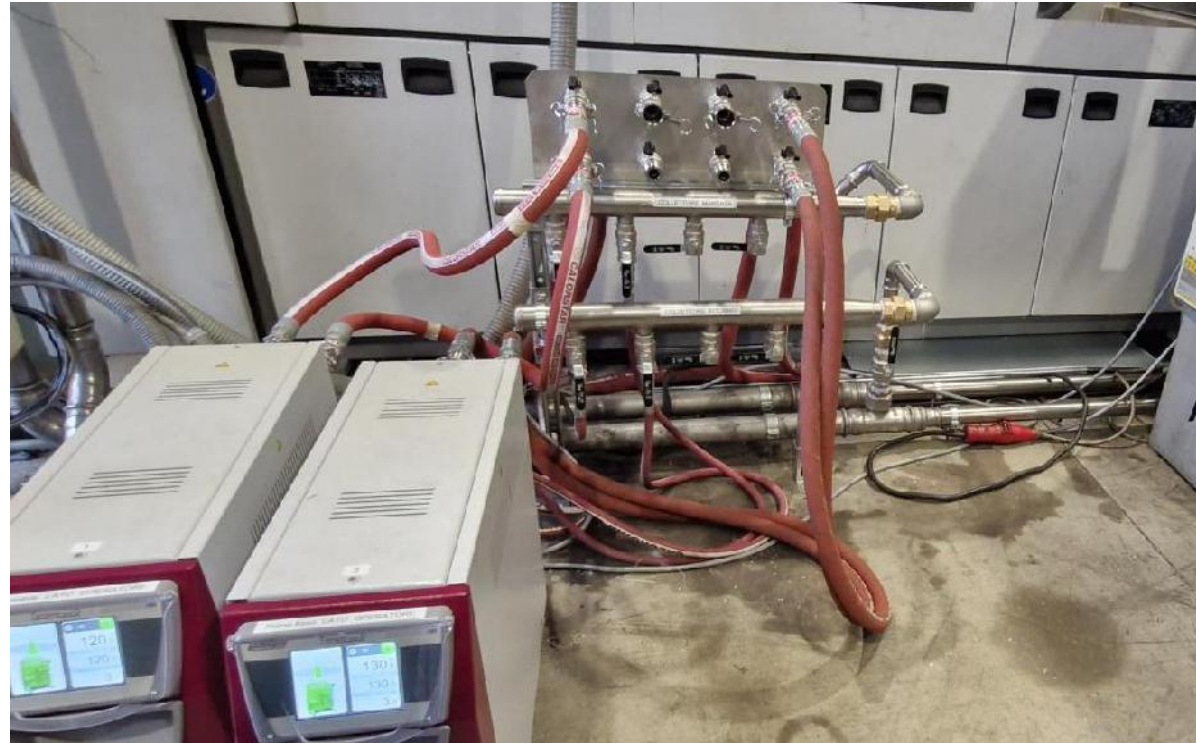
Unabhängiges Warm-Kalt-Managementsystem mit bodenmontierter Verteilerplatte. Starre und flexible Rohre mit 1,5 Zoll Durchmesser.
