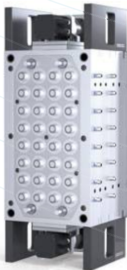
Kundenbeispiel SAH3 32fach Ausschraubhälfte Formgröße 446 x 796 mm (Zahnriemenplatte demontiert) Customer sample SAH3 32x unscrewing half Mold size 446 x 796 mm (timing belt plate demounted)
