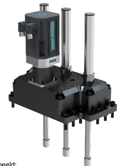
Klantvoorbeeld: SLA-3L met 100kN maximale drukkracht en 55kN nominaal - snelheid 50mm/sec.
